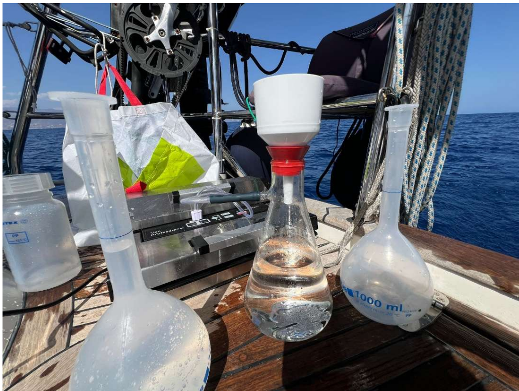
Abbildung 8 Aufbau der Saugflasche mit aufgesetztem Büchner-Trichter und der Vakuum-Maschine im Hintergrund. Eigene Aufnahme vom 02.08.2025
